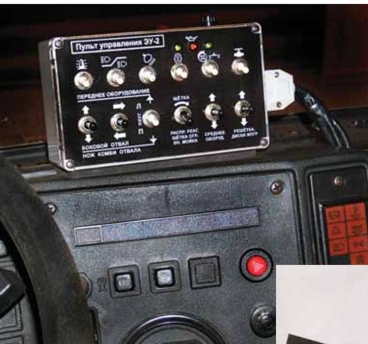
Комплекты для сборки систем электроуправления предназначены для управления из кабины водителя оборудованием для содержания дорог, имеющим электроуправляемый гидрораспределитель.
