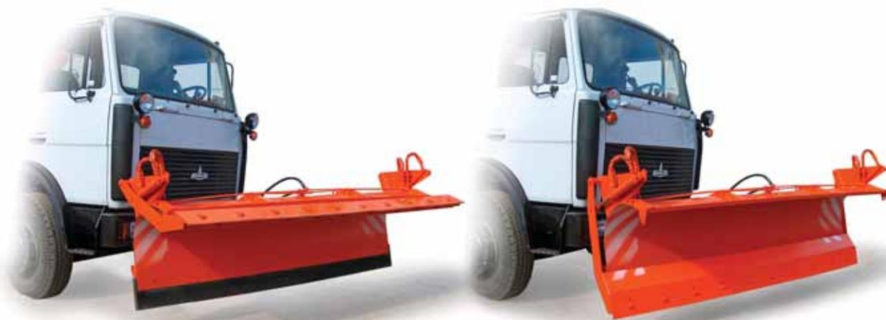
**Отвал** может быть не самосъёмный, или самосъёмный – с ногами и БРСами на гидрорукавах; может уста-навливаться на дорожные машины или самосвалы.
