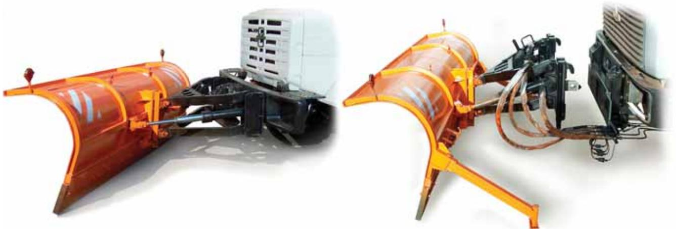
Отвал ОП1 устанавливается на комбинированные дорожные машины на шасси: ЗИЛ, МАЗ, КАМАЗ
