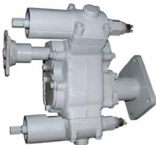
Предназначена для отбора мощности от силового агрегата автомобиля для привода механических и гидравлических устройств спецнастройки. Отбор мощности производится от правого бокового люка коробки передач.
